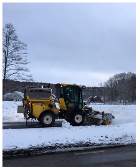
Foto: sopsaltning av cykelväg.
