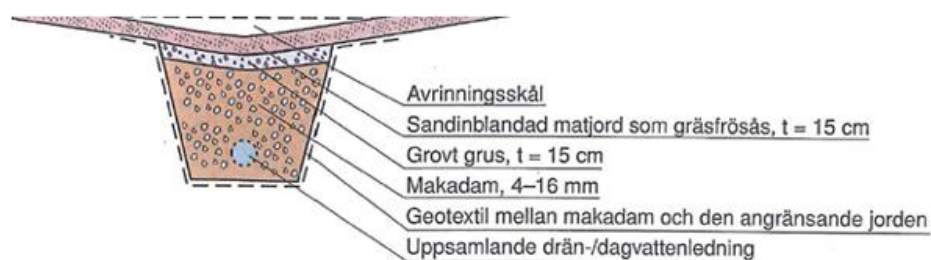
Figur 19. Dräneringsstråk utan dagvattenintag. (Svenskt Vatten P105, 2011)
