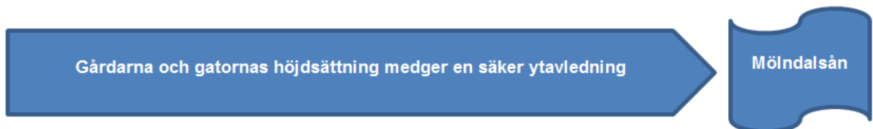
Figur 2. Illustration av dagvattensystem när systemen är överbelastade.
