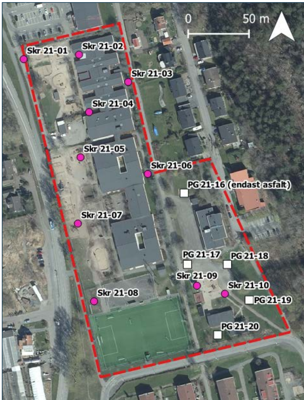
Figur 5. Lågen för provgropar (PG) markerat med vita kvadrater och skruvborrpunkter (Skr) med rosa cirklar. Grundvattenrör installerades i Skr 21-01 och Skr 21-05.
